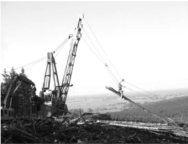
Fig. 3 Swing Yarder »Madill« 124 Slika 3. Šumska žičara s hvatom Madill 124
